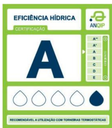
Exemplo de etiqueta para sistemas de duche ou só cabeça de duche
